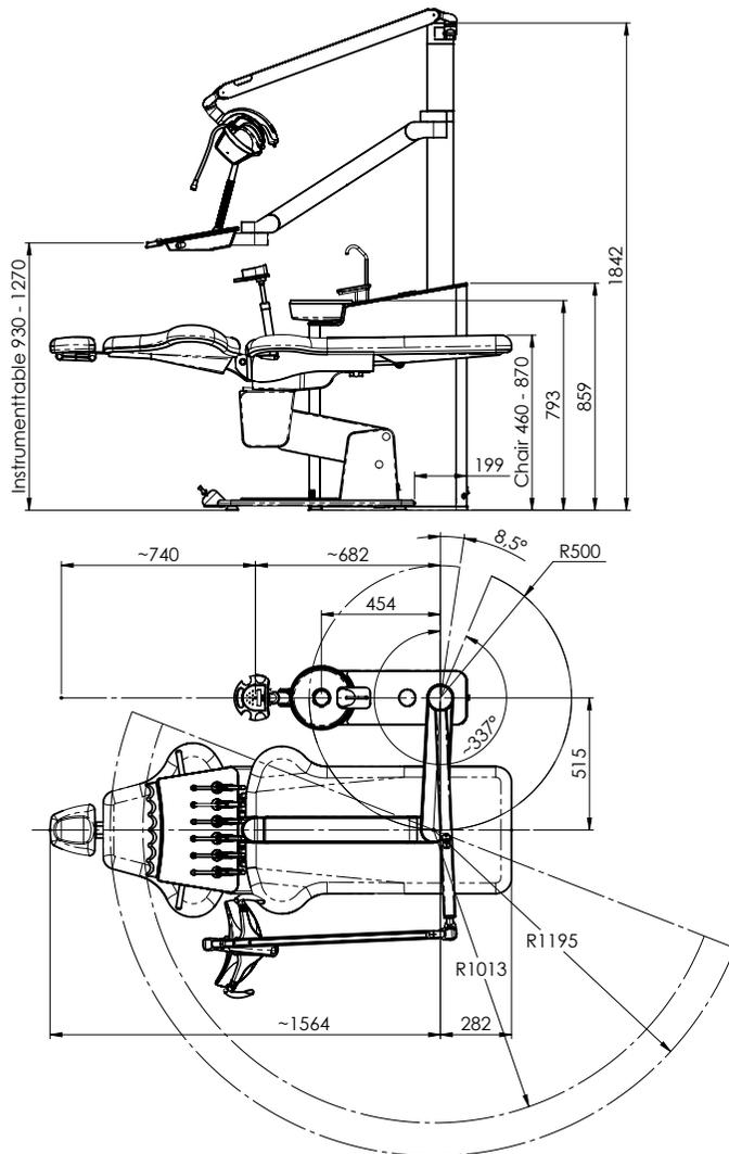
Denne tegning er baseret på en UnicLine S med integreret fontæne.
